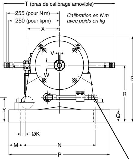
Eau de refroidissement, raccord pour tuyaux Ø intérieur 10 mm
