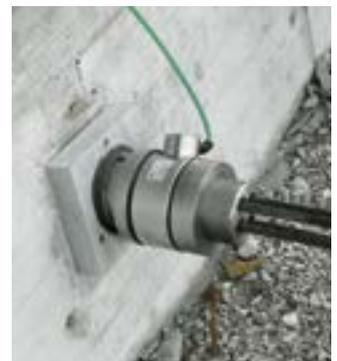
Fig.2: HRL-4-1000 (4 brins) monté sur un ancrage à câble
