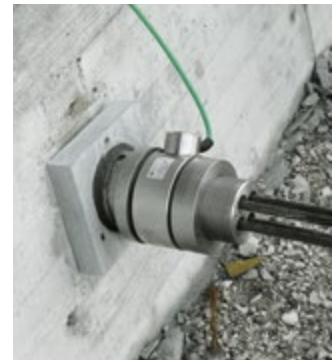
Bild 2: HRL-4-1000 (4 Litzen) montiert auf Litzenanker
