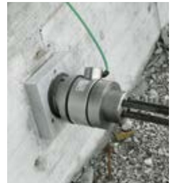
Bild 2: HRL-4-1000 (4 Litzen) montiert auf Litzenanker
