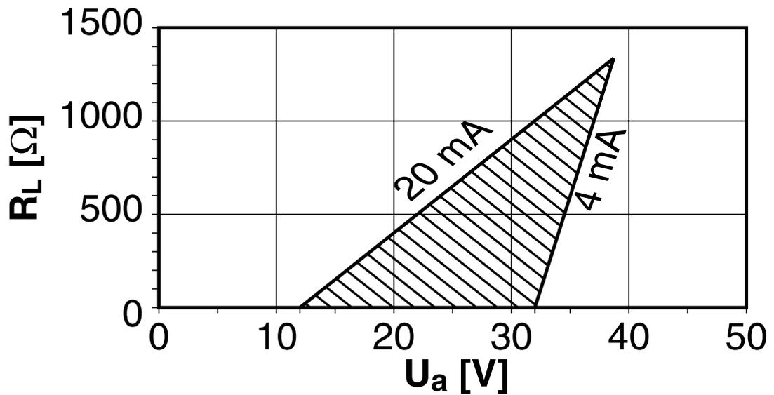
Fig. 4-9 : Plage de fonctionnement de l'axe LE
