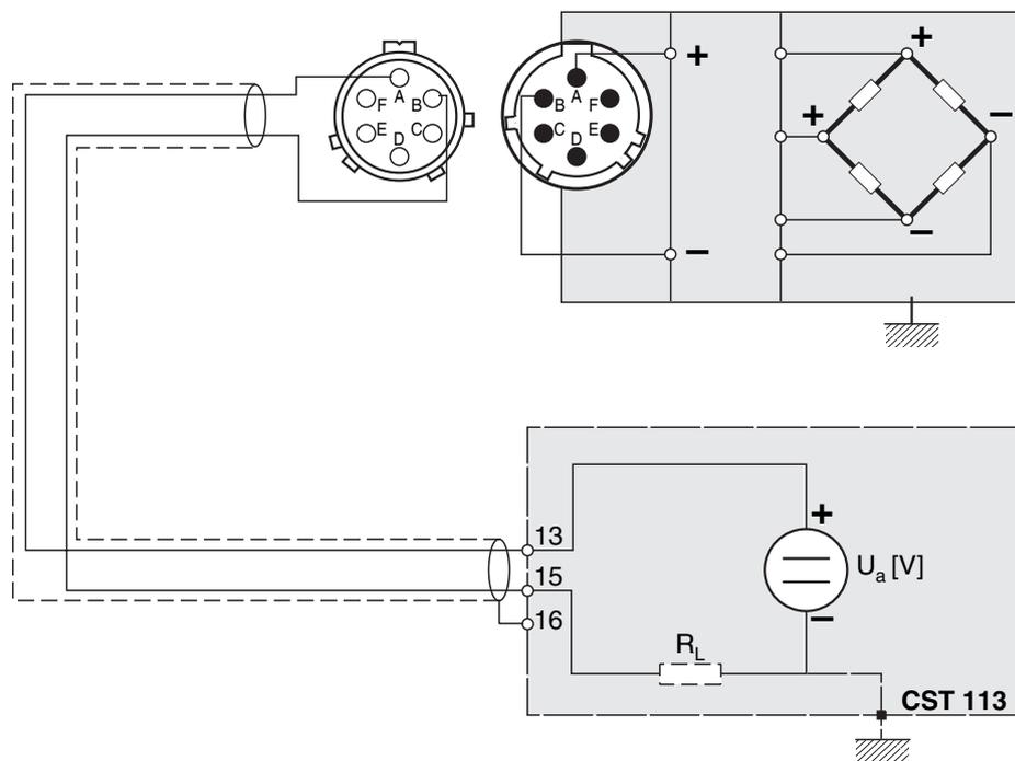
Fig. 4-7 : Schéma de branchement de l'axe LE
