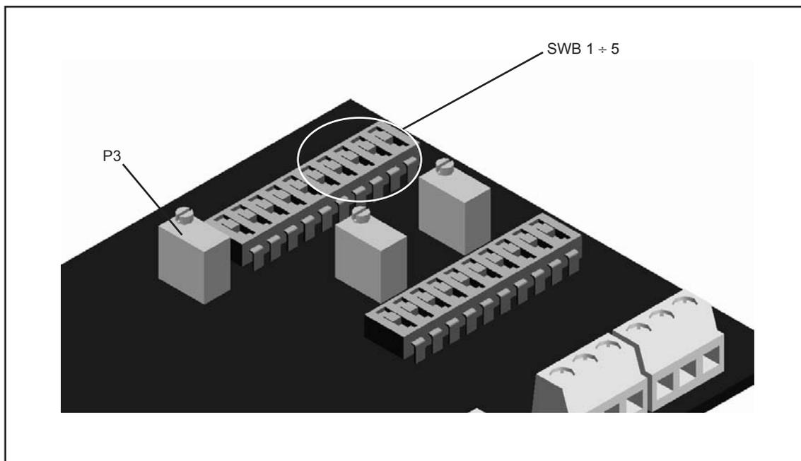
Fig. 5-7 : Position des micro-interrupteurs SWB 1 ÷ 5 et du potentiomètre P3
