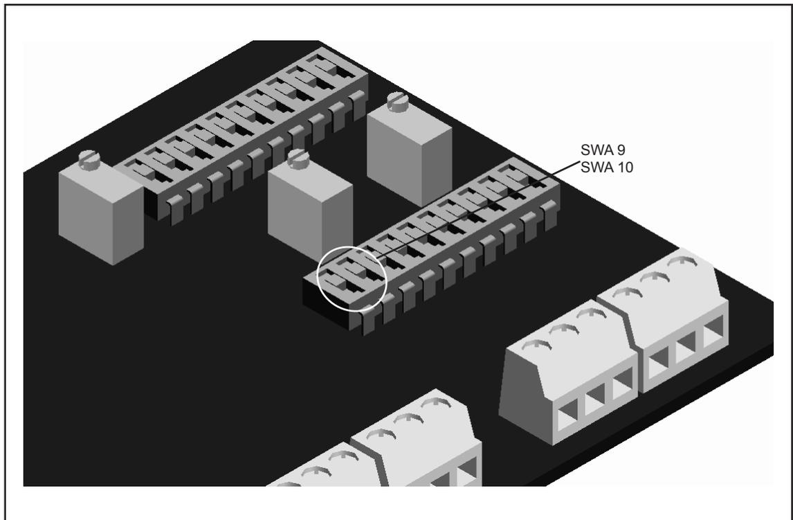
Fig. 5-3 : Position des micro-interrupteurs sur le circuit
