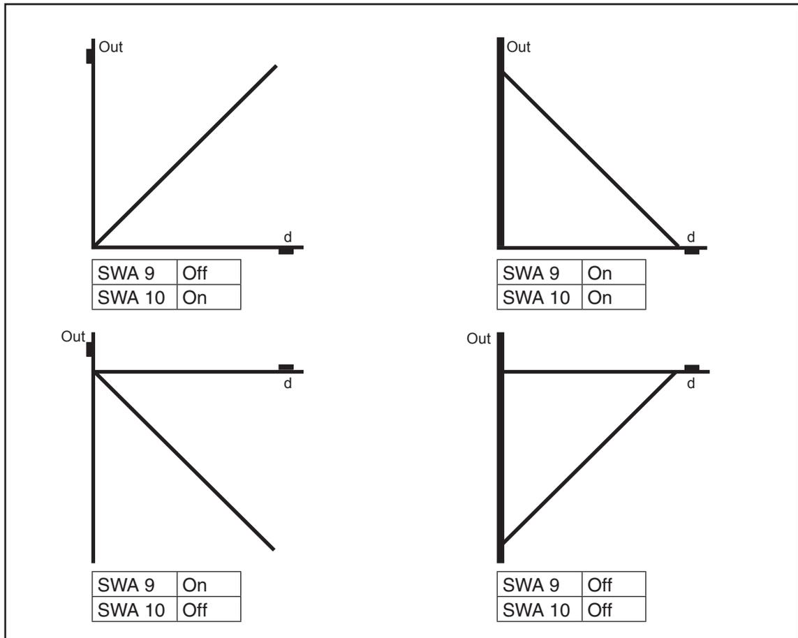
Fig. 5-5 : Configuration des micro-interrupteurs SWA 9 et SWA 10
