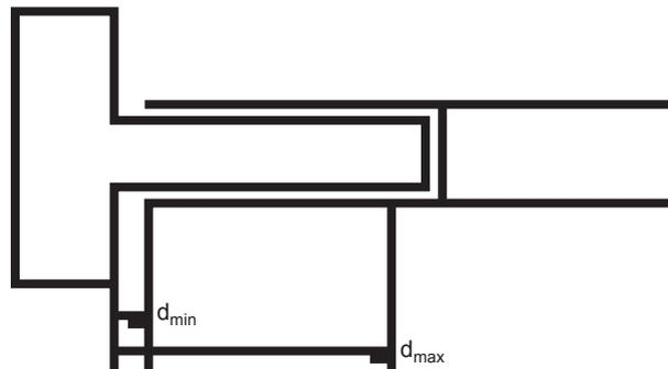
Fig. 5-1 : Déplacement mécanique du tube de mesure
