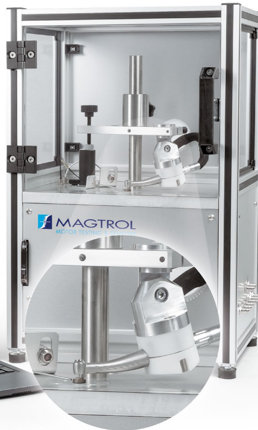
Ci-dessus, un système MSD complet avec son banc de test ainsi que l'ordinateur (option) intégrant le logiciel MSD-TEST (inclus). Le banc d'essai est configuré avec une fixation pour pièce à main. Sur le côté droit, se trouve l'interface d'entrées/sorties analogiques configurables.
