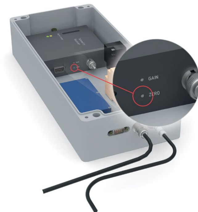
Fig.3-4 Zero Calibration of «5W Conditioner» (TF 318 ... TF 320 Sensors)
