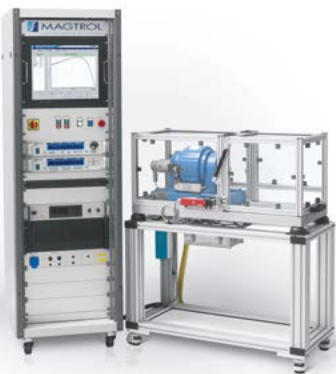
Bild 6: Kundenspezifisches Motorprüfsystem mit WB Series Bremse
