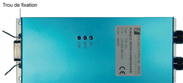
Figure 2-2 Trous de fixation du TSC 401
