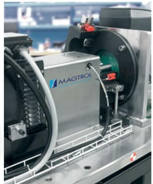
Bild 2-12 Prüfstand mit festem und abnehmbarem mechanischem Schutz, gesichert durch einen Sicherheitsschalter
