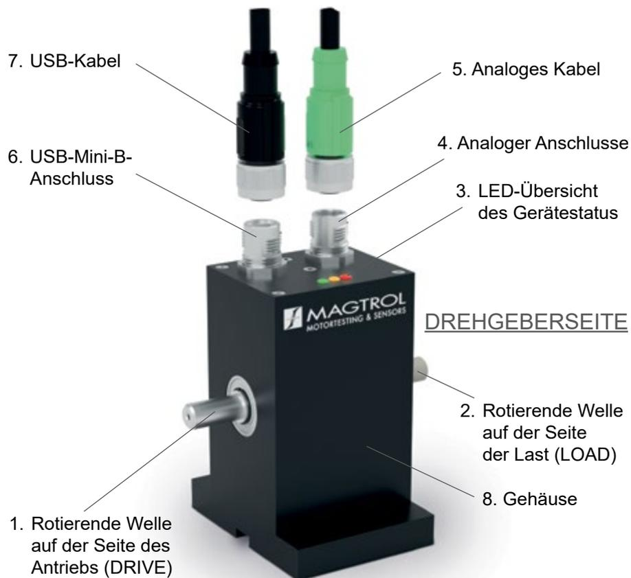
Bild 1-2 Beschreibung der verschiedenen Teile des TS Serie Drehmomentsensors
