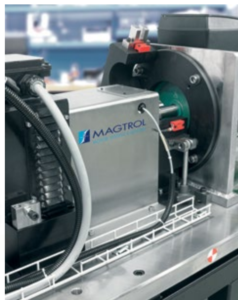
Fig.2-12 Banc d'essai avec protection mécanique fixe et amovible, sécurisée au moyen d'un interrupteur de sécurité.
