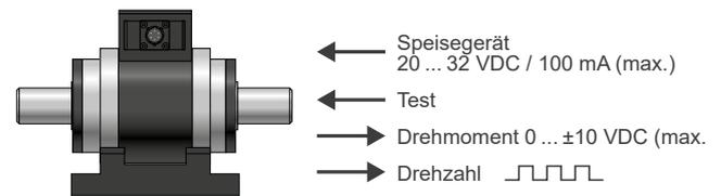
Bild 3: Elektrische Eingänge und Ausgänge des TM 300 Series
