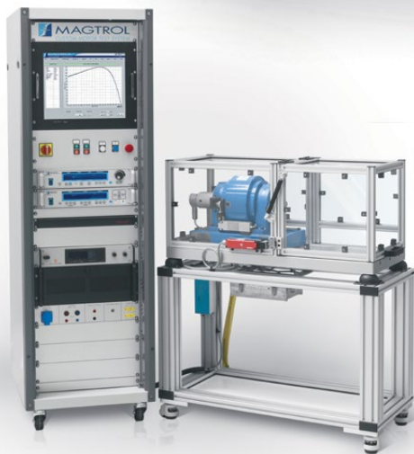
Fig.2-26 Banc d'essai personnalisé, avec armoire de commande et protection mécanique de toute la table de travail.
