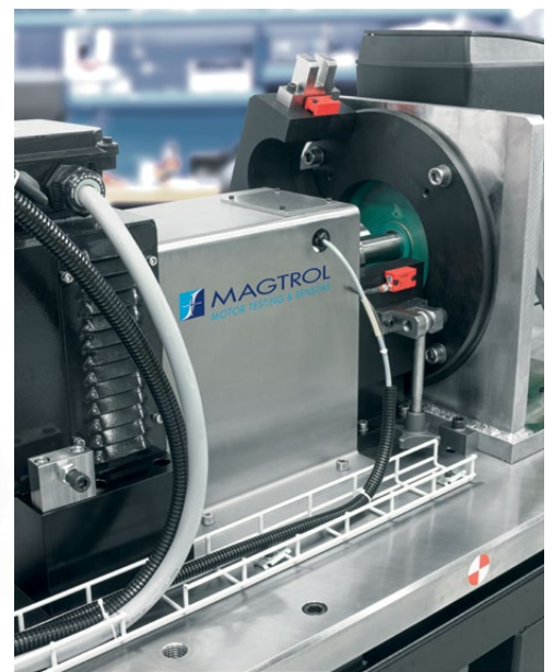
Fig.2-24 Banc d'essai avec protection mécanique fixe et amovible, sécurisée au moyen d'un interrupteur de sécurité.
