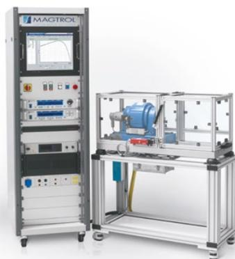
Bild 6: Kundenspezifisches Motorprüfsystem mit WB Series Bremse
