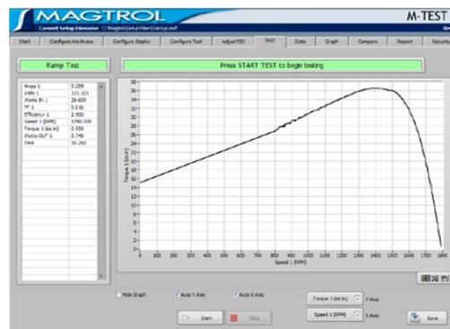
Bild 1 : M-TEST 7 Motorenprüfsoftware
