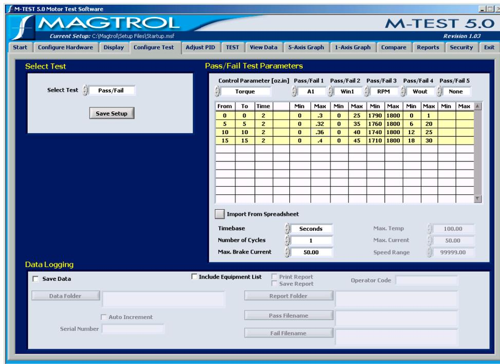
Bild 8–5 Pass/Fail Test-Konfigurationsfenster
