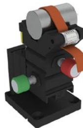
Die Leistungsbremsengrundplatte ist mit einer Vorrichtung zur Befestigung von Mikro- und Miniaturmotoren ausgerüstet, welche eine höchst präzise Positionierung und Zentrierung des geprüften Motors in allen drei Achsen X, Y und Z gewährleistet. Die im Lieferumfang beinhalteten Adapter ermöglichen es, problemlos Motoren mit Durchmessern von 5 bis 3 mm zu montieren. Keile und ein elastisches Sicherungsband mit Rändelklemmvorrichtung halten den Motor sicher in Position.
