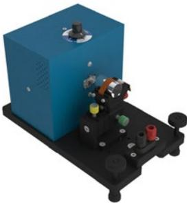
Micro Dyne verwendet das einzigartige Hysteresebremsensystem von Magtrol, welches schon im Stillstand ein Drehmoment erzeugt. Damit kann der zu prüfende Motor demzufolge vom Leerlauf bis zum blockierten Rotor hoch- und heruntergefahren werden.
