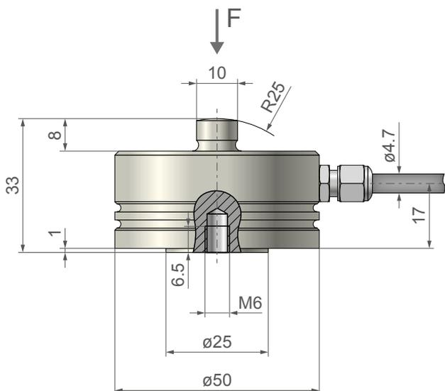
**ACHTUNG:** das abgeschirmte Anschlusskabel ist in der Standardausführung nicht am Aufnehmergehäuse angeschlossen.
