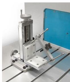
Positionierung und Ausrichtung haben einen großen Einfluss auf die gemessenen Parameter (Reibungsmoment). MAGTROL empfiehlt dringend, die Prüflinge mit einer speziell hierfür entwickelten Halterung zu befestigen, um die besten Positioniertoleranzen in X-Y und deren Wiederholbarkeit zu gewährleisten
