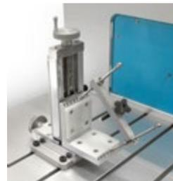
Positionierung und Ausrichtung haben einen großen Einfluss auf die gemessenen Parameter (Reibungsmoment). MAGTROL empfiehlt dringend, die Prüflinge mit einer speziell hierfür entwickelten Halterung zu befestigen, um die besten Positionier toleranzen in X-Y und deren Wiederholbarkeit zu gewährleisten
