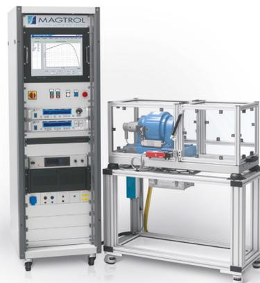
Fig. 3: Banc de test personnalisé avec freins WB Series
