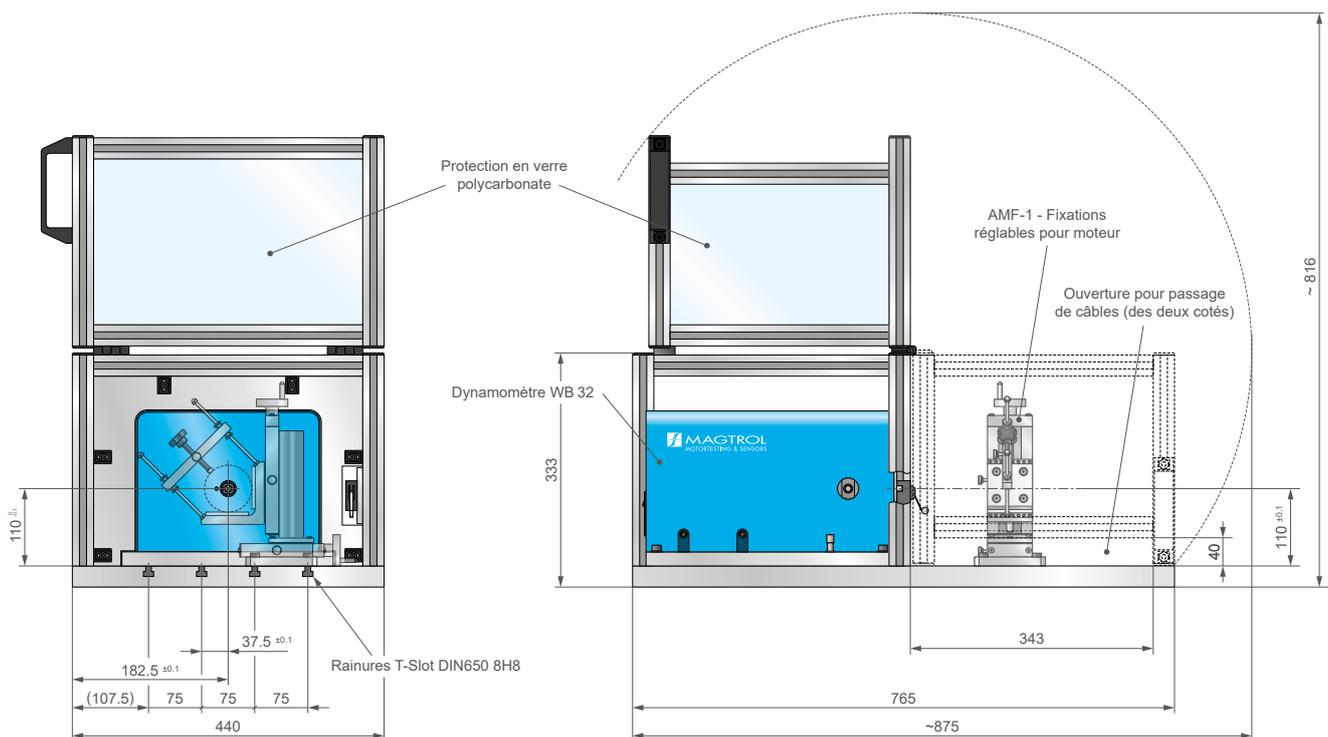
Le dynamomètre WB 32 peut être intégré comme composant d'une chaîne de mesure.
