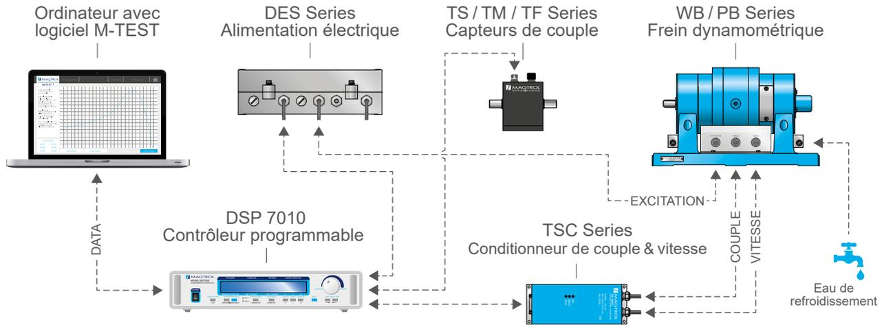
Fig. 2: Configuration du frein dynamomètre WB Série avec ses accessoires
