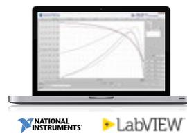
Le logiciel M-TEST de Magtrol (basé sur Windows®), est un programme informatique ingénieux pour l'acquisition des données lors d'un test de moteur. Utilisé avec un contrôleur programmable de freins dynamométriques de Magtrol (ex.
