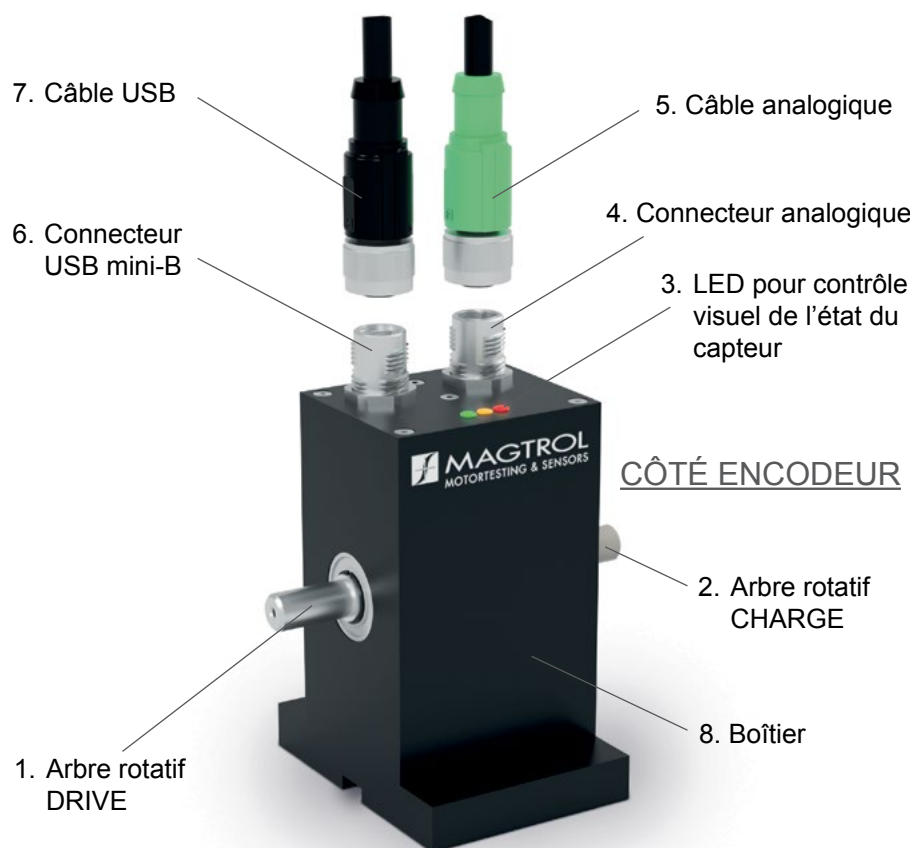
Fig.1-2 Description des différentes parties du capteur de couple TS Série
