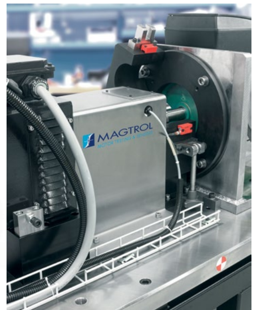
Fig.2-12 Banc d'essai avec protection mécanique fixe et amovible, sécurisée au moyen d'un interrupteur de sécurité.
