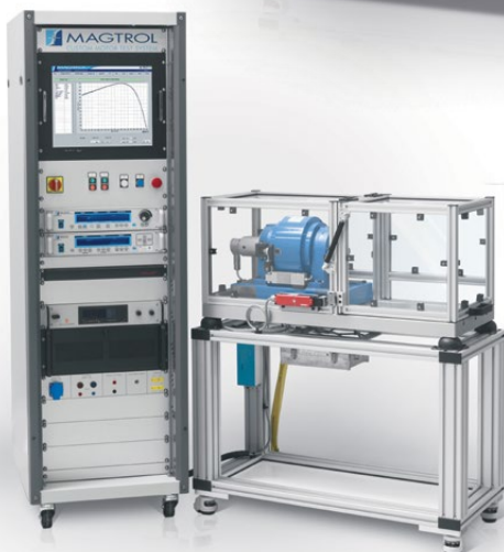
Bild 2-14 Kundenspezifischer Prüfstand, mit Steuerschrank und mechanischem Schutz des gesamten Prüffeldes
