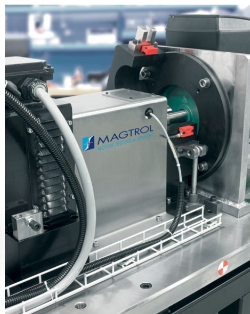
Bild 2-12 Prüfstand mit festem und abnehmbarem mechanischem Schutz, gesichert durch einen Sicherheitsschalter
