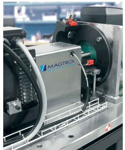
Bild 2-24 Prüfstand mit festem und abnehmbarem mechanischem Schutz, gesichert durch einen Sicherheitsschalter.
