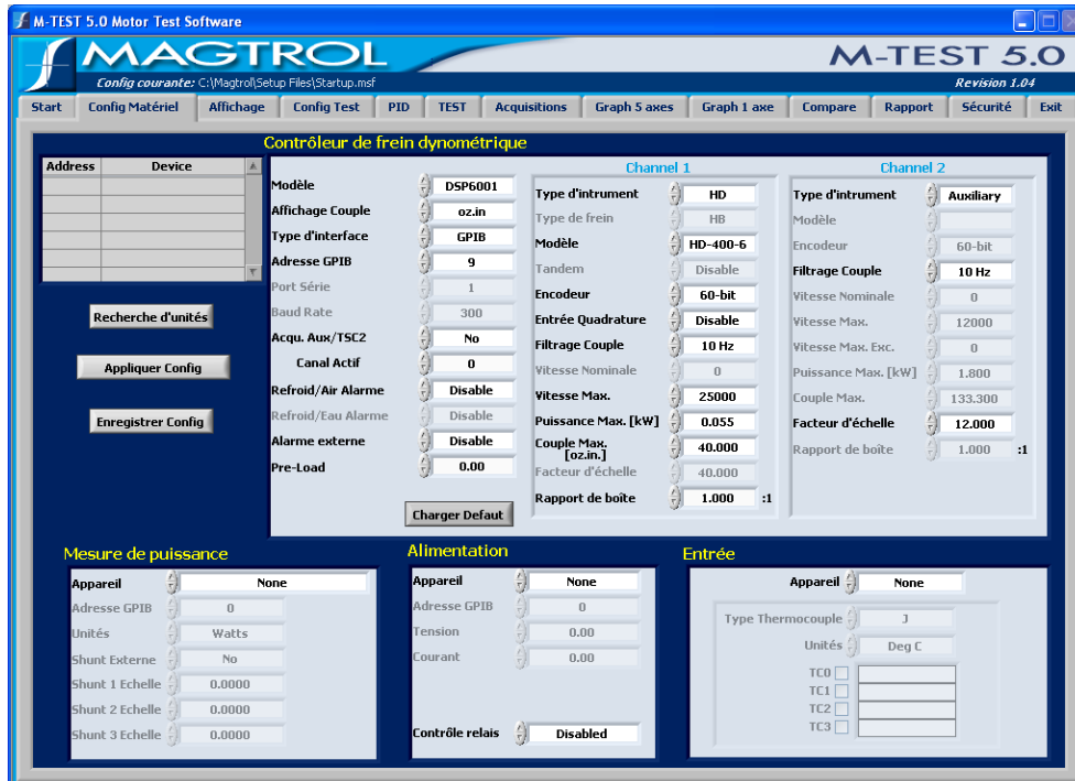
Figure 5-1 Fenêtre de configuration du logiciel M-TEST 5.0
