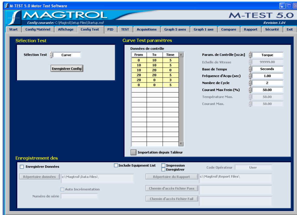
Figure 7-6 Configuration d'une courbe de charge asservie en couple
