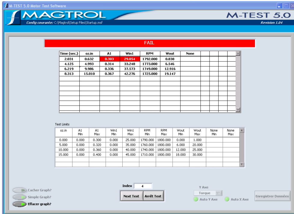
Figure 7-11 Affichage des résultats d'un test Pass/Fail (test non réussi)
