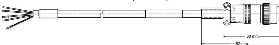
Ensemble de raccordement de l'axe dynamométrique au LMU avec contre-fiche droite
