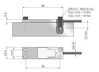
Fig. 2: Dimensions et indication du couple de serrage à appliquer aux vis
