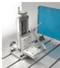
Le positionnement et l'alignement ont une grande influence sur les paramètres mesurés (couple de frottement). MAGTROL recommande d'utiliser un support spécifiquement dédié aux produits à tester pour assurer les meilleures tolérances de positionnement dans X-Y, ainsi que sa répétabilité.
